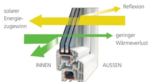
Zeitgemäße Fenster und allen voran die Fenster von Hoco, bilden einen optimalen Rahmen für die effiziente Nutzung von Energie: Der Wärmeverlust im Winter ist minimal – aber jeder Sonnenstrahl trägt zur Erwärmung des Innenraums bei.
